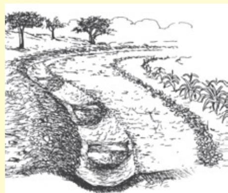
Acequias de ladera
